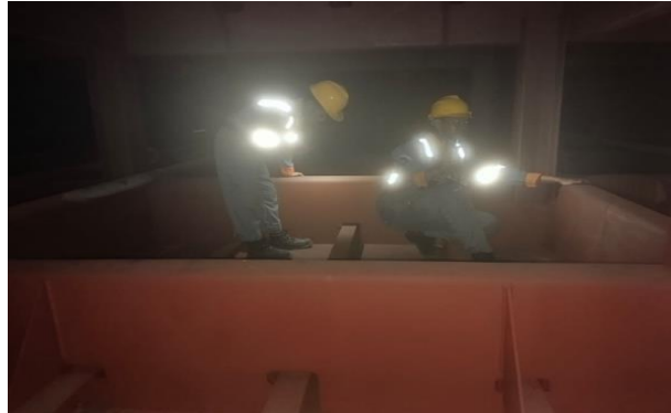
Gambar 2. 3 Proses pemeriksaan kebocoran pada tanki water tank dan double bottom crane barge
