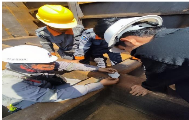
Gambar 2.39 Belajar menggunakan Welding Gauge
