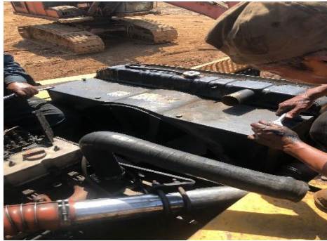
Gambar 2 15 Radiator mesin excavator yang rusak
