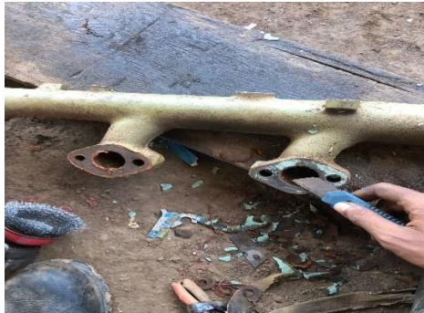
Gambar 2 11 Membersihkan bagian mesin menggunakan pisau cutter
