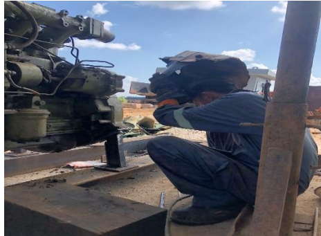
Gambar 2 19 Proses mengelas dudukan mesin
