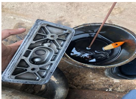
Gambar 2 8 Membersihkan bagian pada mesin kompresor
