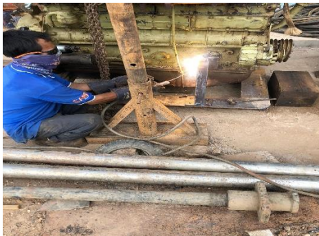
Gambar 2 20 Proses mengelas dudukan mesin
