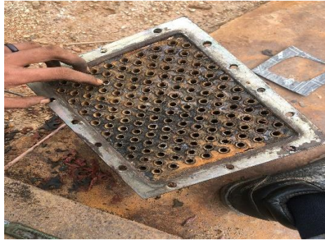
Gambar 2 9 Membersihkan lem yang lengket di bagian radiator
