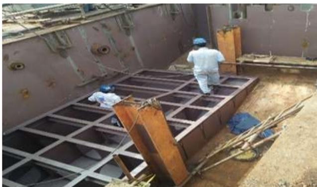
**Gambar 2.3 Bagian Tangki Kapal Yang Di Fabrikasi**
