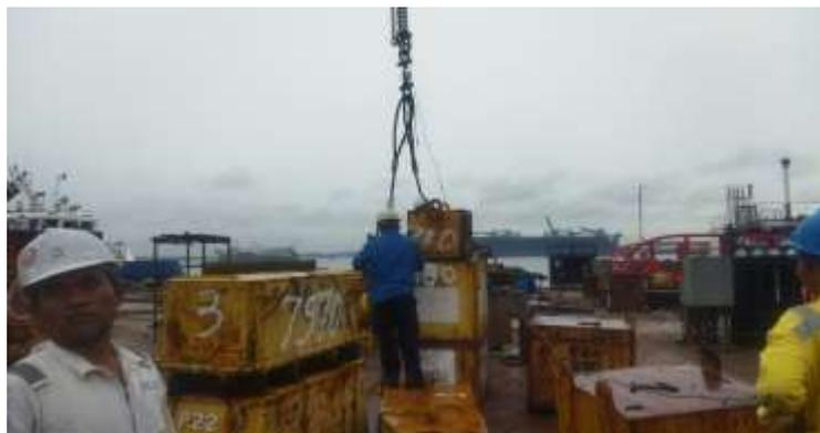
**Gambar 3.3 Penimbangan Beban Untuk Proses *Inclining Test***
