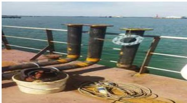
**Gambar 2.29** proses pemasangan *Air Vent Head*
