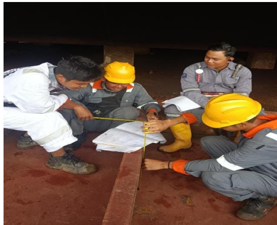
Gambar 2. 22 pengecekan fanel kontruksi skeg kapal tongkang.
