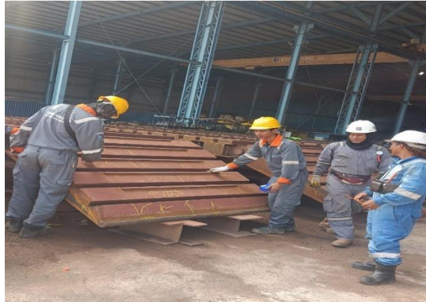
Gambar 2. 27 inspect welding terhadap ramp door
