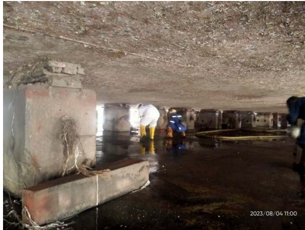
Gambar 2.31 Pengecekan Bottom Dan Keel
