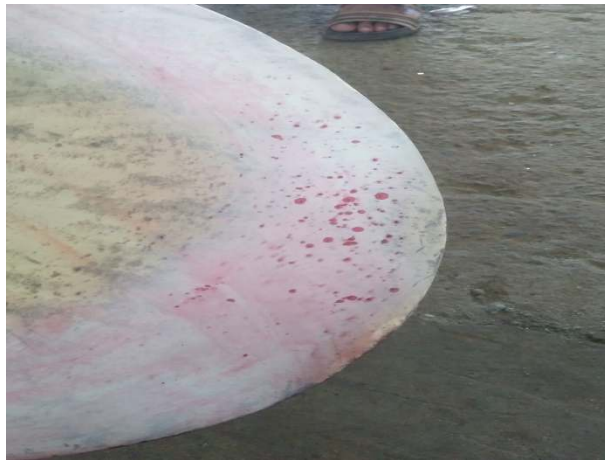
Gambar 2.16 Propeller Saat Uji Penetrant
