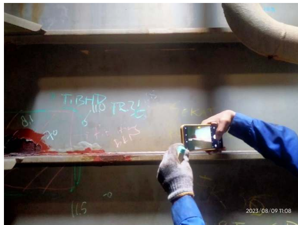
Gambar 2.37 Pengecekan Plat Sisi Pada WBT
