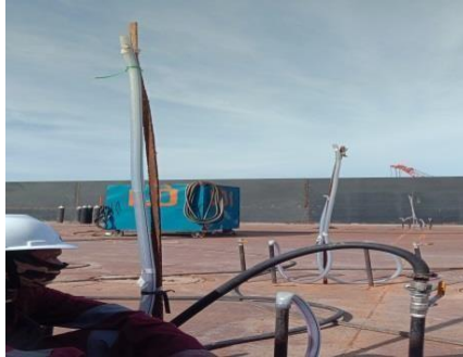
Gambar 1. 19 air test pada tangki 9-11
