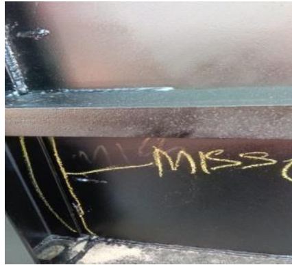
Gambar 1. 32 mis welding pada support sideboard
