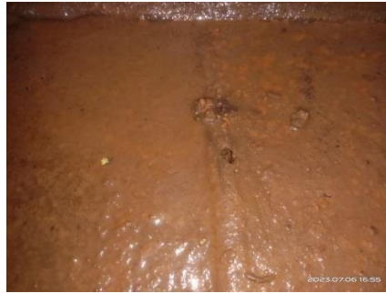
Gambar 1. 17 bocor pada plat bottom
