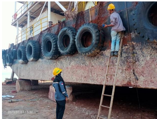
GAMBAR 2. 15 proses UT bodi kapal tongkang.
