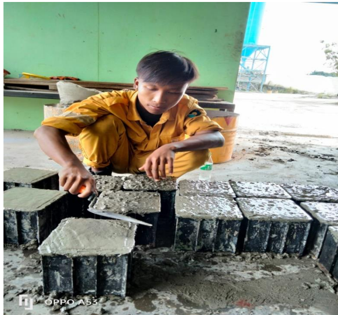
Gambar 3. 9 Pembuatan sample kubus
