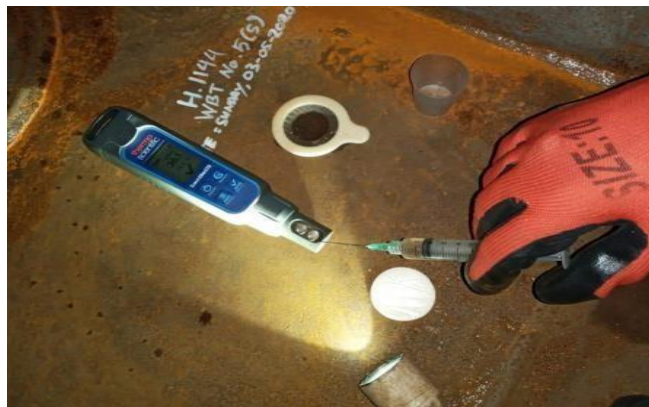
Gambar 2. 47 Pengecekan kadar garam pada pasir
