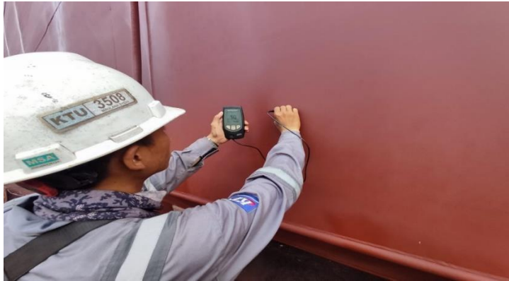
Gambar 2. 55 dft di top side
