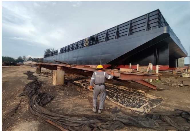
Gambar 2. 50 Membahas tentang proses pengerjaan blasting dan painting hull 1645
