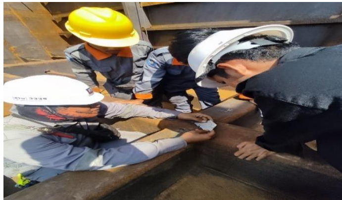
Gambar 2. 44 Belajar menggunakan Welding Gauge
