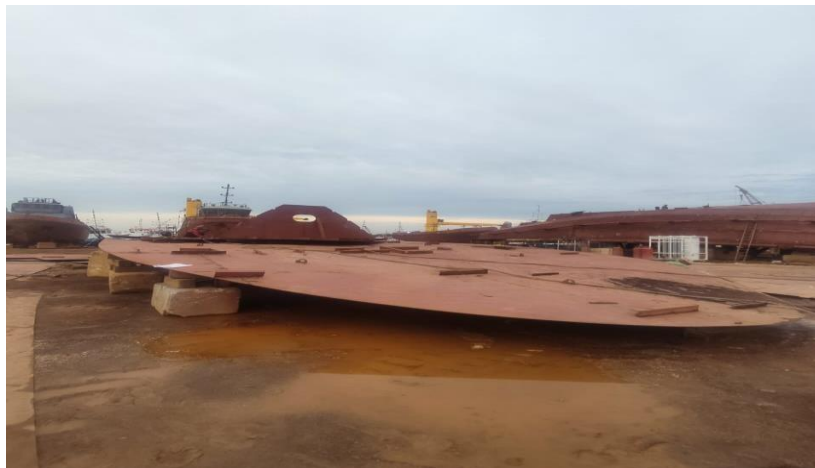
Gambar 2. 22 proses awal pembangunan kapal tug boat
