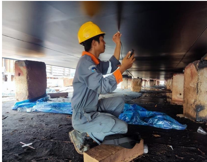
Gambar 2. 52 pengekan ketebalan cat dgn menggunakan alat dft
