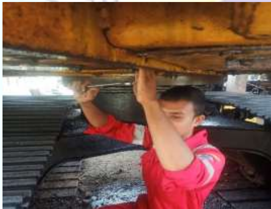
Gambar 4.5 pemeriksaan pada kondisi baut
