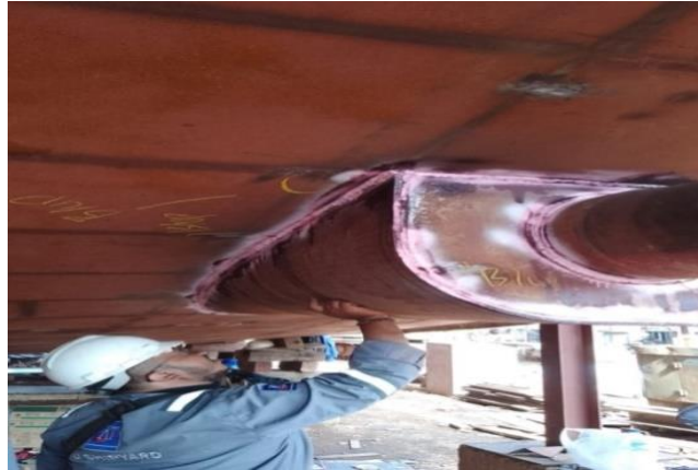
Gambar 2.3 proses penetrant test di bagian bagian cover stern tube
