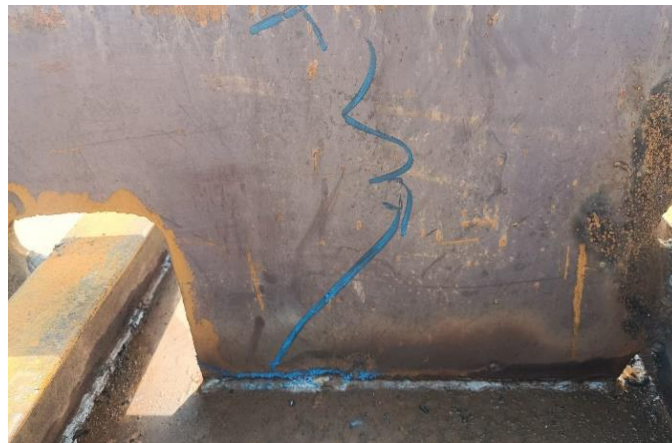
Gambar 2.46 undercut pada pengelasan
