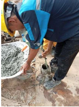
Gambar 3.68 Pemadatan beton uji slump (Sumber : Dokumentasi pribadi, 2023)
