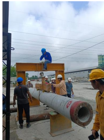
Gambar 3. 12 Pengujian Bending Sumber: Dokumentasi KP 2023
