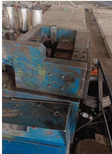
Gambar 3. 14 Pembuatan Kepala Paku Sumber: Dokumentasi lapangan KP 2023
