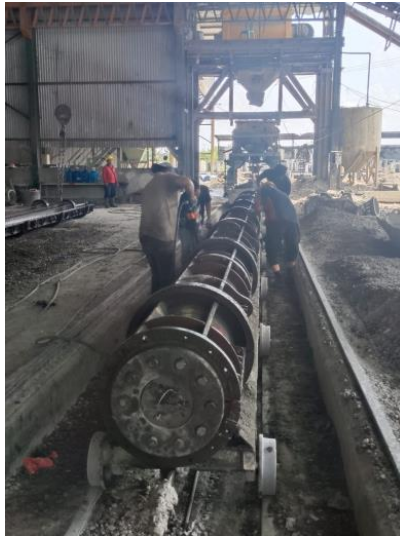
Gambar 3. 18 Pemasangan Tutup Moulding
