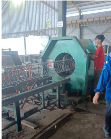
Gambar 3. 15 Pengelasan Tulangan Sumber: Dokumentasi lapangan KP 2023
