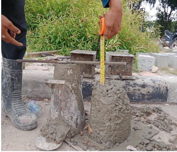
Pekerjaan pengujian slump
