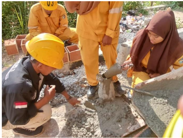
Pekerjaan pembuatan benda uji kubus
