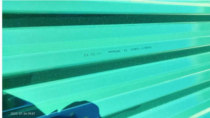
Gambar 3. 3 Atap seng gnek-dek 0,30 mm uk.40x6 m Sumber : Dokumentasi lapangan, 2023
