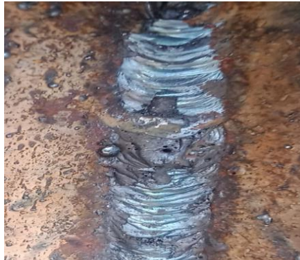
Gambar 2. 3 Cacat las Porosity
