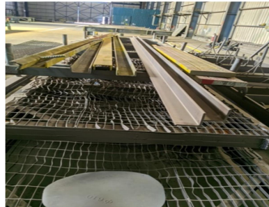
Gambar 2.23 Material setelah blasting
