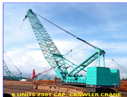
Gambar 3.1 Crane kapasitas 250 ton
