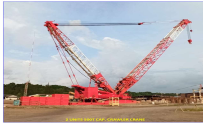
Gambar 3.2 Crane kapasitas 500 ton
