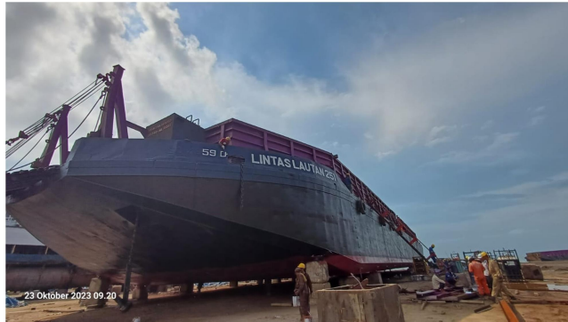
Gambar 3.8 Tongkang Lintas Lautan 251 setelah dipasang zinc anode.
