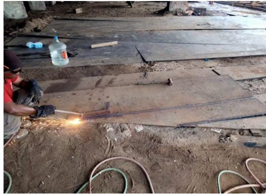
Gambar 2. 39 Pematongan tulangan Skeg
