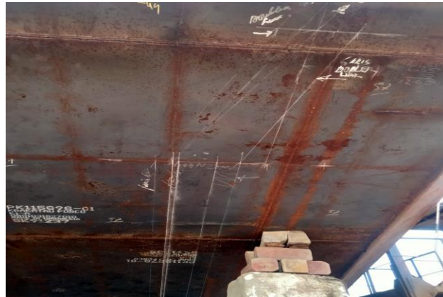
Gambar 3. 5 Marking bawah buritan
