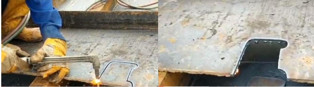
Gambar 3.4. Cutting manual dan hasil yang diperoleh
