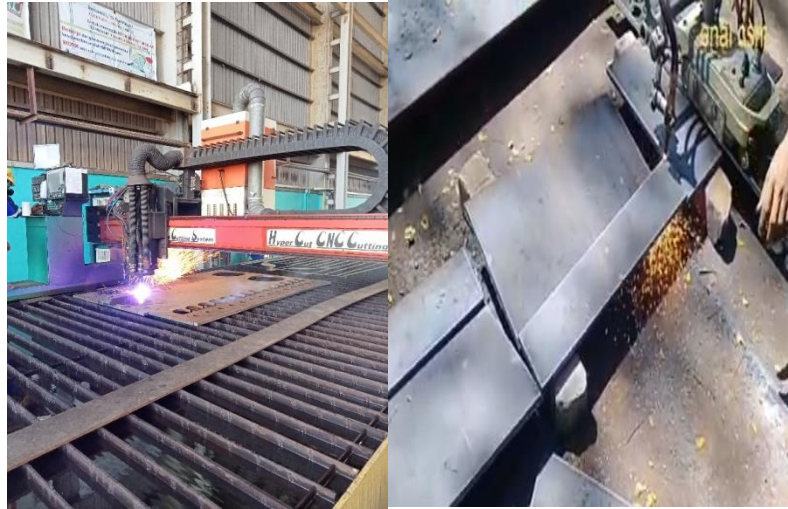
Gambar 3.5. Cutting dengan mesin CNC dan hasilnya
