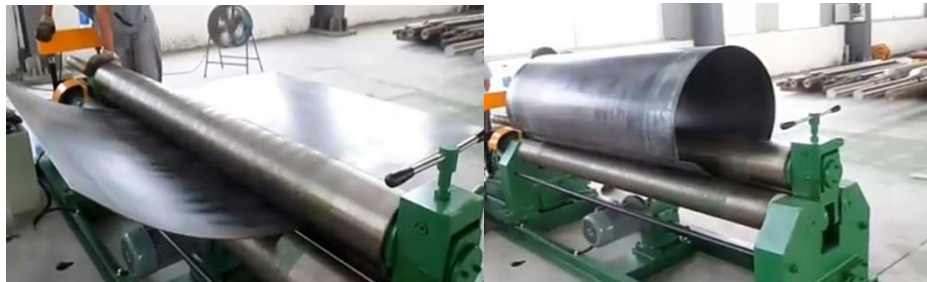
Gambar 3.6. Proses bending plate dan hasilnya
