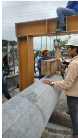
Gambar 3. 35 Pengujian bending Sumber : (Dokumentasi KP 2023)
