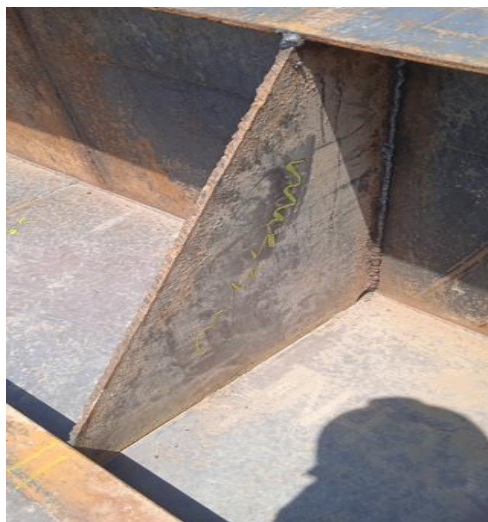
Gambar 4.22 Miss welding pada Bracket
