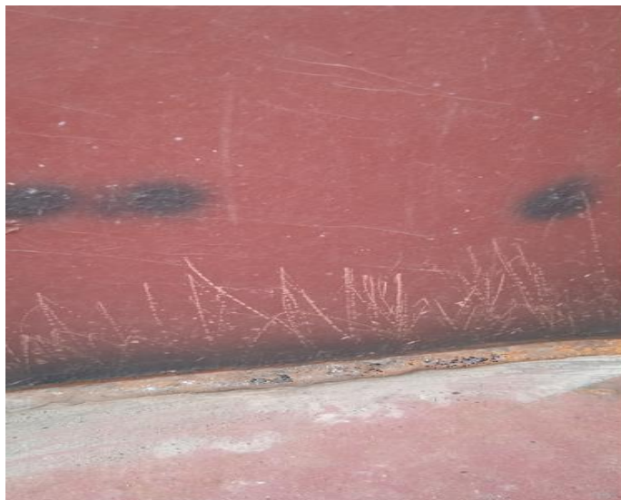
Gambar 3.38 Cacat pengelasan pada bagian Bottom
