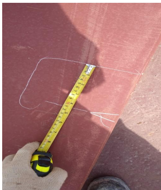
Gambar 3.13 Proses pengukuran pada lubang Noces
