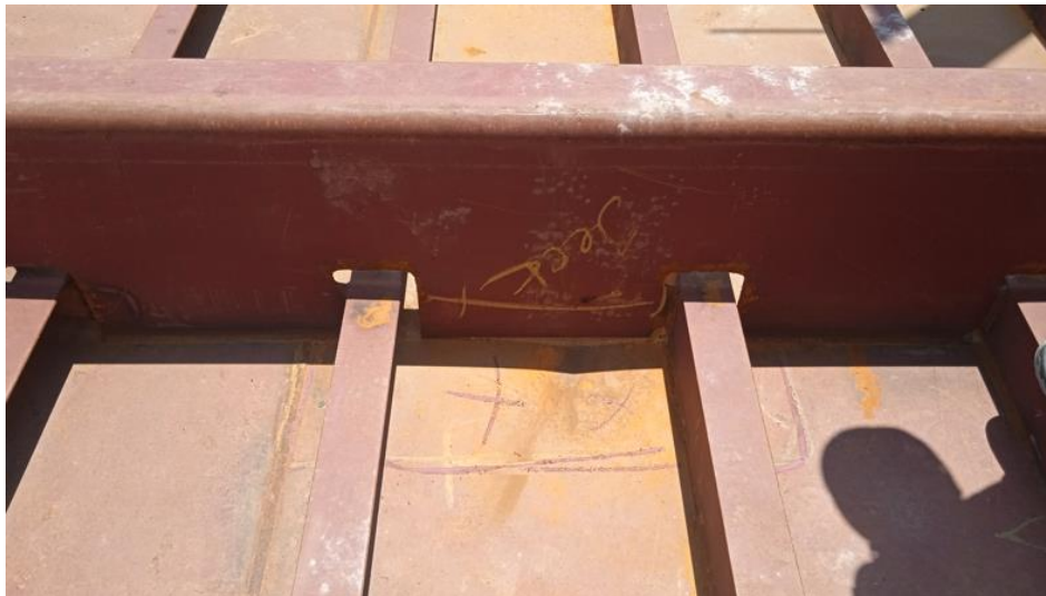
Gambar 4.23 Plat Bottom yang melengkung
