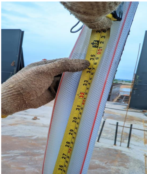
Gambar 6.23 Ketinggian air yang tidak sesuai standard
