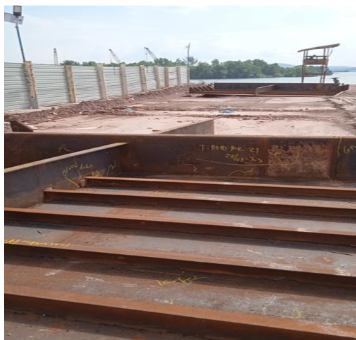
Gambar 3.29 Visual inspeks pada bagian T.bhd Hull 025
