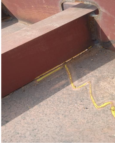
Gambar 3.32 Miss Welding pada bagian Eagle
