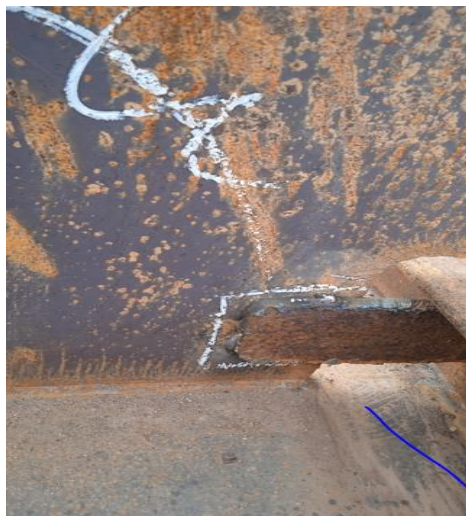
Gambar 4.10 Visual inspeks bagian T.bhd class BKI
