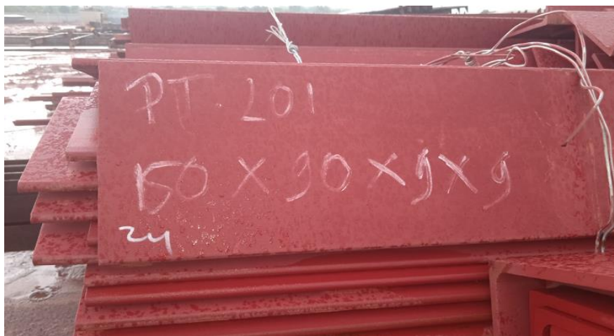
Gambar 4.18 Pengecekan ukuran Eagle untuk Bottom
