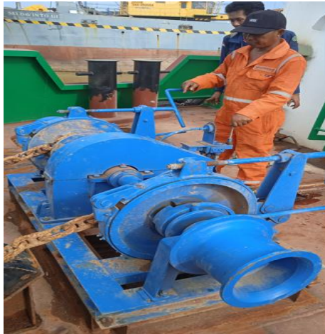
Gambar 5.17 Comisioning mesin jangkar
