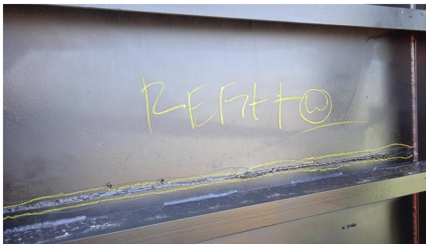
Gambar 2.27 Cacat pengelasan pada side board
