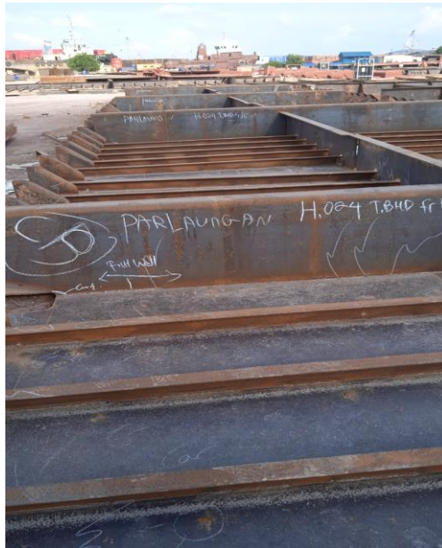
Gambar 3.6 Visual inspeks T.bhd Hull 024
