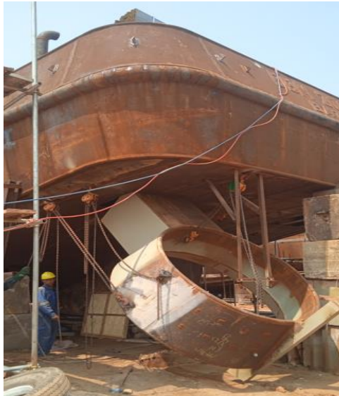
Gambar 5.7 Pemasangan Kort Nozzle
