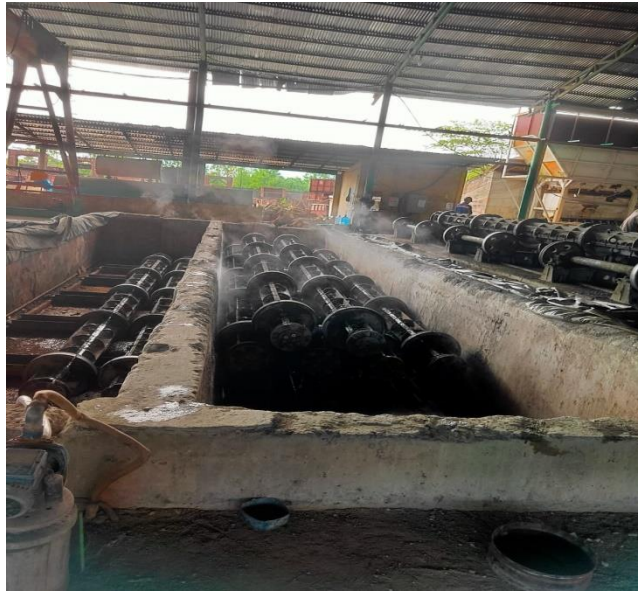
Gambar 3.25 : Masa penguapan di bak steam
