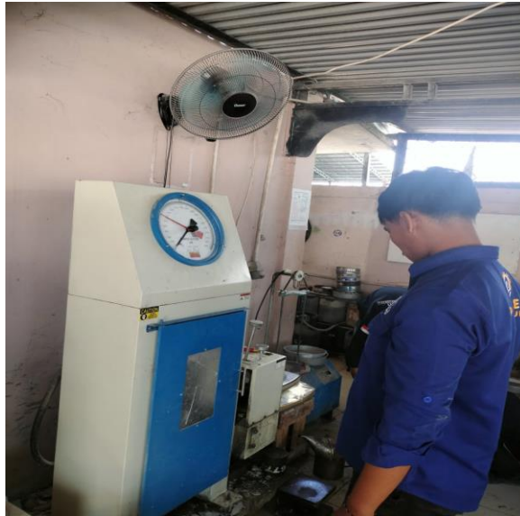
Gambar 3.13 Pengujian kuat tekan
