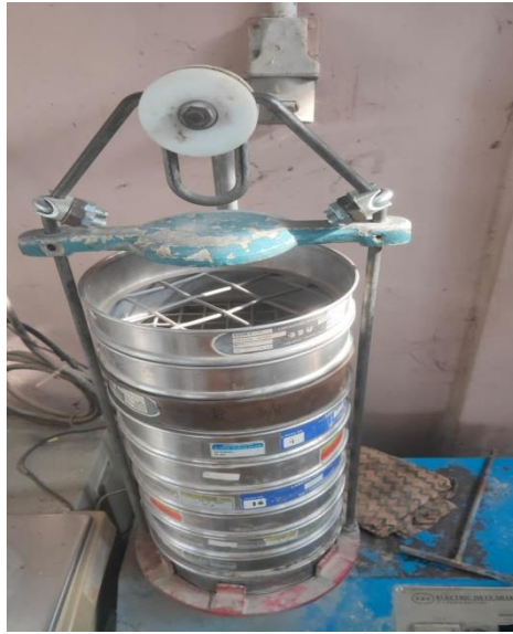
Gambar 3.10 : Proses Pengujian Analisa saringan
