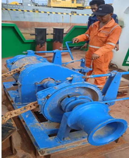
Gambar 2.143 Comisioning mesin jangkar
