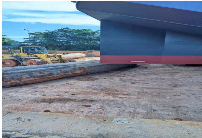
Gambar 3.8 proses pendorongan badan kapal
