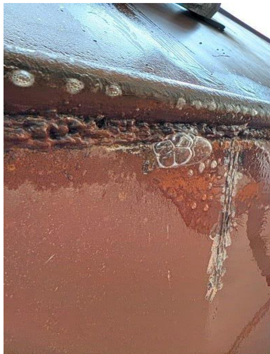
Gambar 2.11 Gambar salah satu titik kebocorsn pada bagian roanbar
