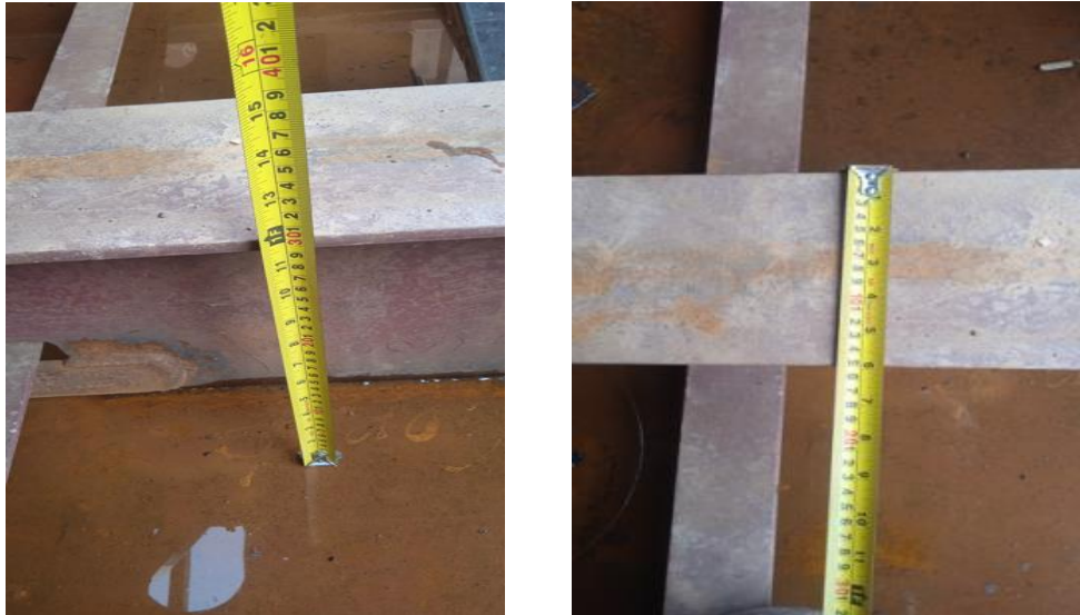
Gambar 2.131 Pengukuran Web Beem
