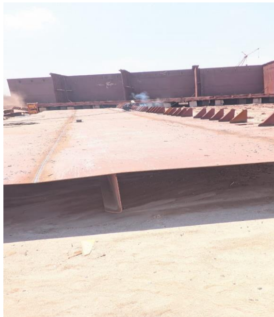
Gambar 2.112 Gambar L.bhd yang sudah dibalikkan
