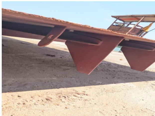
Gambar 2.109 Gambar balikan T.bhd yang sudah dibalikan
