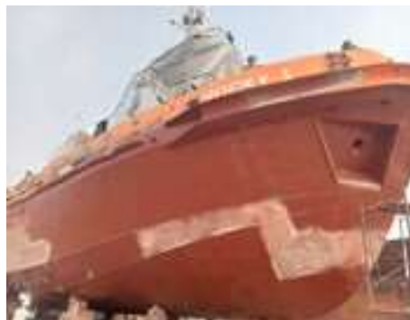
Gambar 2.48 Pengecatan Primer Coat
