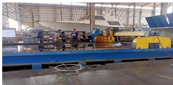
Gambar 2.50 Proses CNC lubang noces pada web girder
