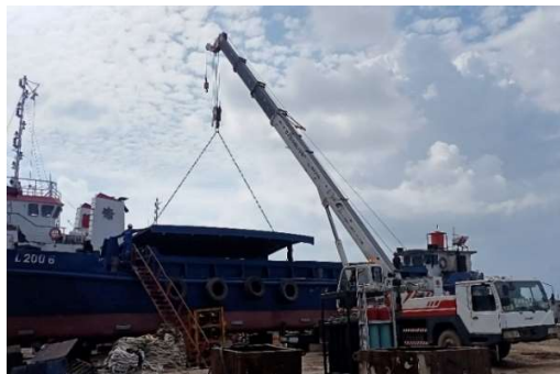
Gambar 2.51 Proses Pengakatan tutup palkah tongkang L 2006
