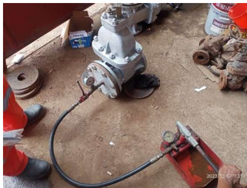
Gambar 2.76 Hidro test Valve kapal T.033 Jx walrus
