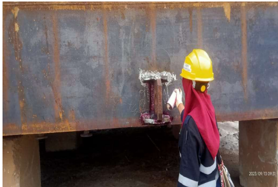
Gambar 2.57 Penetran test kupingan blok frame 0-29 T.033 Louis Dolphin
