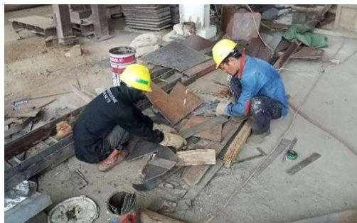
Gambar 2.38 Control Pematangan Bracket 200 x 200 Kapal T.036 Louis Dholphin
