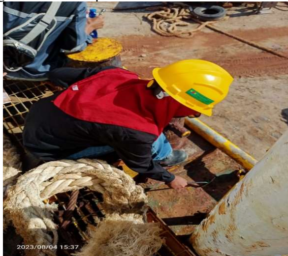
Gambar 2.28 UT Main Deck Bagian Buritan Kapal KHB.DREGER
