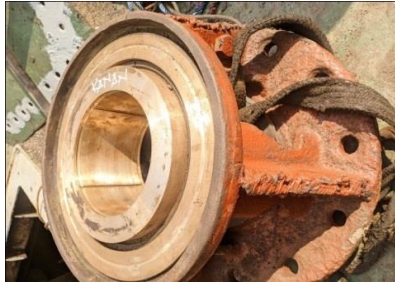
Gambar 3.1 17 pembongkaran rudder carrier
