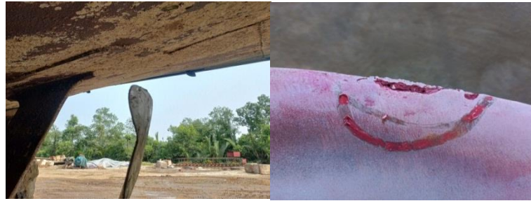
Gambar 3.1 8 Deformasi dan porosity pada daun propeller
