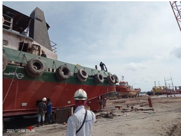
Gambar 2 22 proses pemasangan dafra TB TRT
