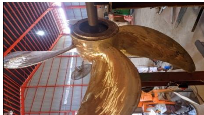
Gambar 3.1 23 penyelarasan daun propeler
