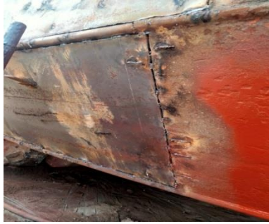
Gambar 2 30 plate yang sudah diganti
