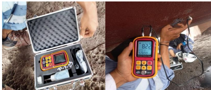
Gambar 2 37 mengecek ketebalan keel sesebelah kanan kapal
