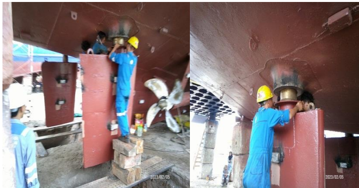
Gambar 3.1 15 penggantian bushing kemudi kanan kiri
