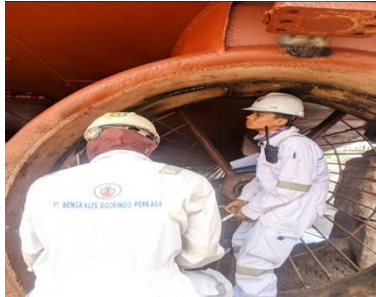
Gambar 2 45 proses pemasangan Propeller TB. Rocky 12.
