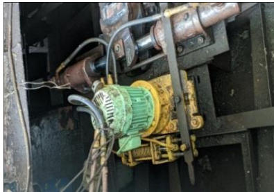
Gambar 3.1 20 pemeriksaan akhir rudder carrier
