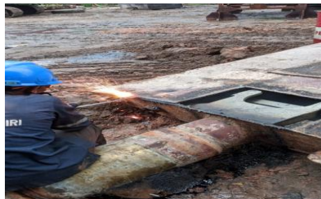
Gambar 2 12 Proses replating pada bagian daun kemudi persada
