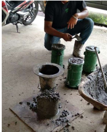
Gambar III.68 3Beton Silinder (Sumber: Dokumentasi Lapangan 2023)
