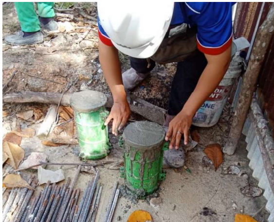
Gambar III.11 Dua Sampel Beton Silinder (Sumber: Dokumentasi Lapangan 2023)
