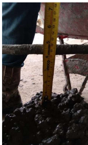
Gambar III.67 Hasil Uji Slump 10,5cm (Sumber: Dokumentasi Lapangan 2023)
