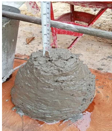
Gambar III.80 Hasil Uji Slump 10,5 cm (Sumber: Dokumentasi Lapangan 2023)
