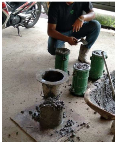
Gambar III.57 3Beton Silinder (Sumber: Dokumentasi Lapangan 2023)
