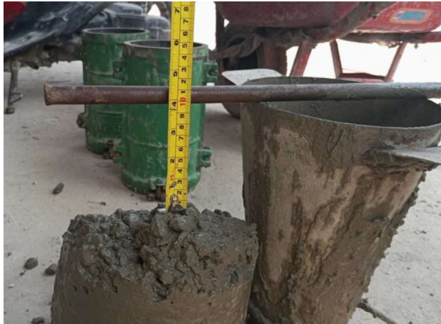
Gambar III.97 Hasil Uji Slump 10,5 cm (Sumber: Dokumentasi Lapangan 2023)
