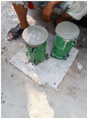
Gambar III.26 Dua beton Silinder (Sumber: Dokumentasi Lapangan 2023)
