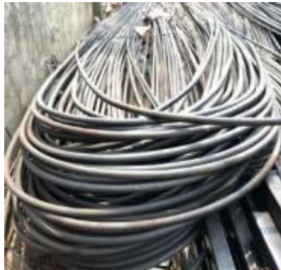
Gambar III.147 Besi Polos (Sumber: Dokumentasi Lapangan 2023)
