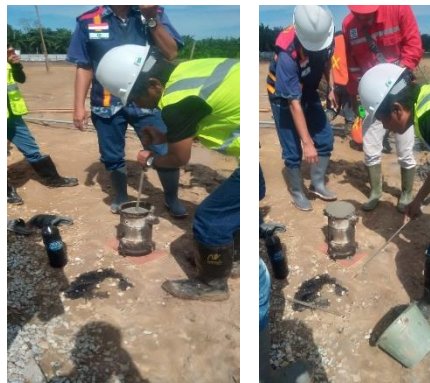
Gambar 3.27 Proses pembuatan sampel beton silinder Sumber : Dokumentasi lapangan
