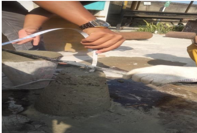
Gambar: 3.12 Uji slump
