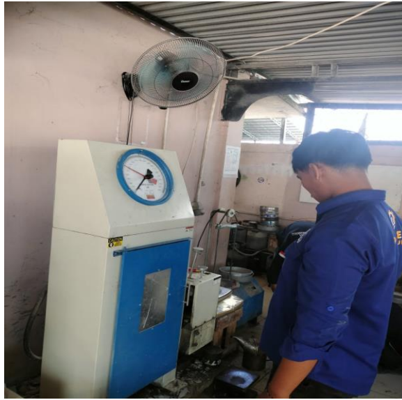
Gambar 3.13 Pengujian kuat tekan
