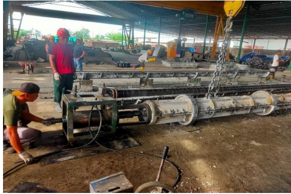
Gambar 3.23 Tahap tarikan stressing Sumber : Dokumentasi lapangan,2023
