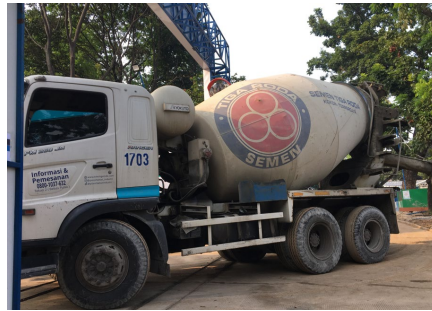
Gambar 3. 23 Mixer truck Sumber : Dokumentasi Lapangan 2023
