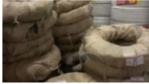
Gambar 3. 34 Kawat bendrat Sumber : Dokumentasi Lapangan 2023
