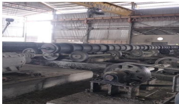
Gambar 3.35 Tahap Spinning tiang listrik
