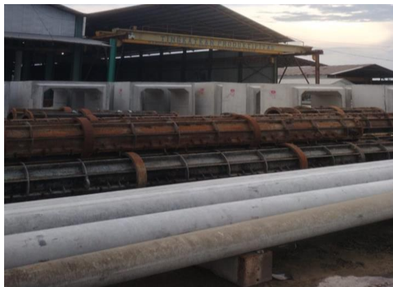
Gambar 3.37 Pembongkaran dari cetakan/ Remoulding. Sumber :Dokumen lapangan, 2023
