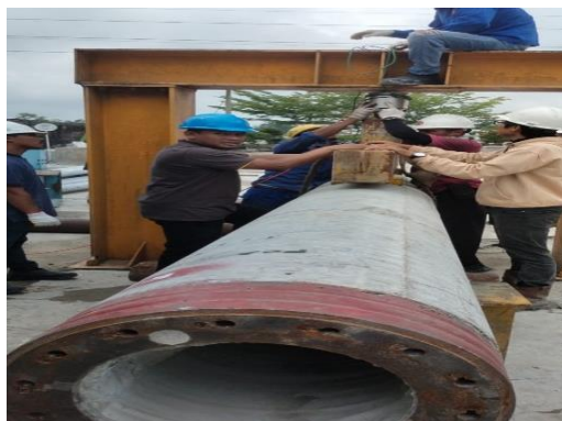
Gambar 3.15 Pengujian bending spun pile Sumber : Dokumen Lapangan KP , 2023
