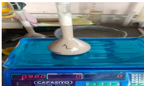
Gambar 3.6 Pengisian agregat halus kedalam pikno meter Sumber : dokumentasi KP, 2023
