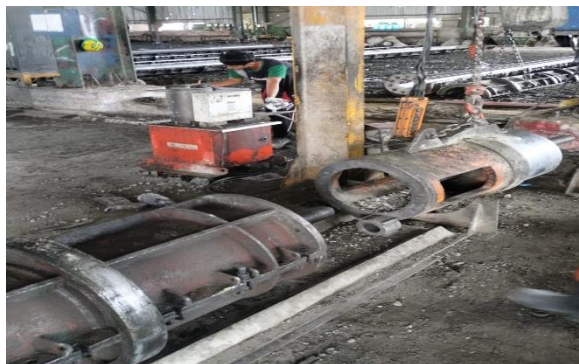
Gambar 3.34 Tahap stressing tiang listrik Sumber :Dokumen lapangan, 2023
