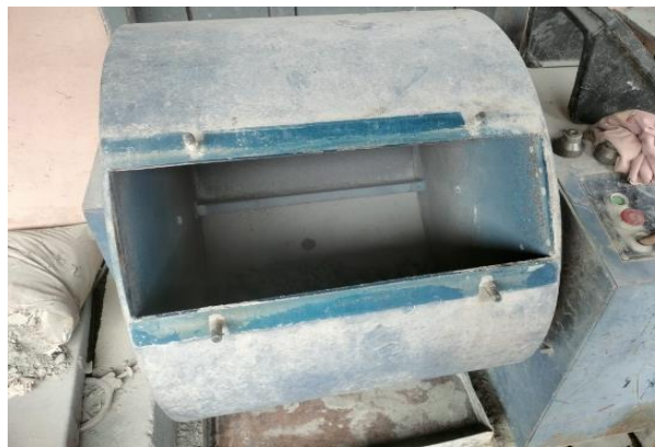
Gambar 3.13 Mesin loss angeles Sumber : Dokumentasi KP,2023
