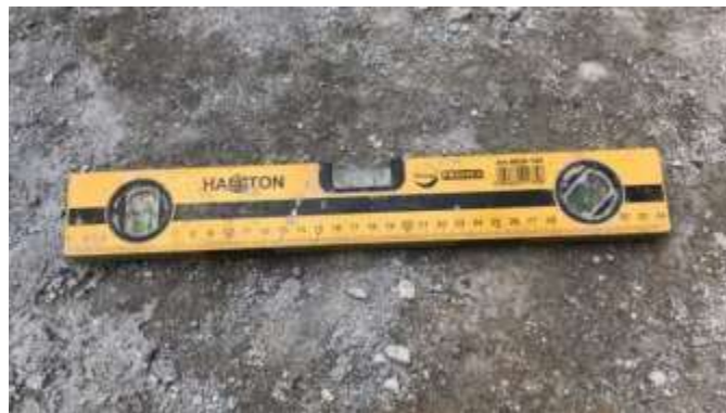
Gambar 3. 143 Waterpass ( Sumber : Dokumentasi Lapangan 2023)
