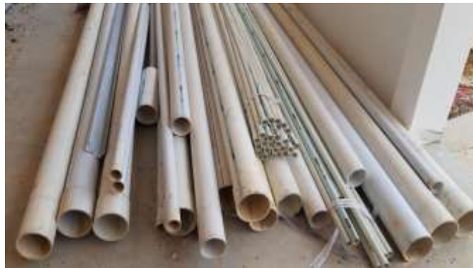
Gambar 3. 111 Pipa PVC ( Sumber : Dokumentasi Lapangan 2023)
