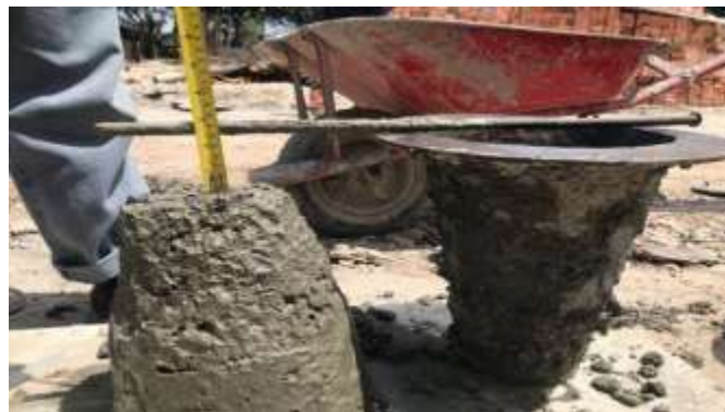
Gambar 3. 25 Proses Uji Slump ( Sumber : Dokumentasi Lapangan 2023)
