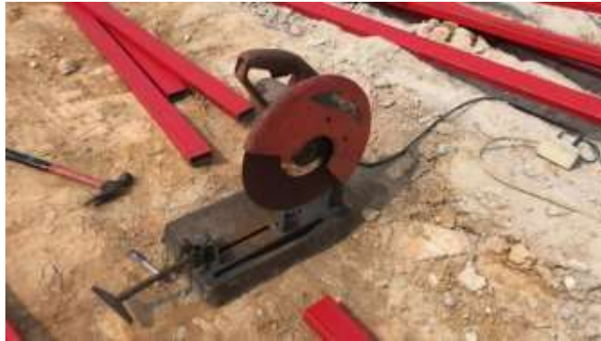
Gambar 3. 132 Cutting wheel ( Sumber : Dokumentasi Lapangan 2023)
