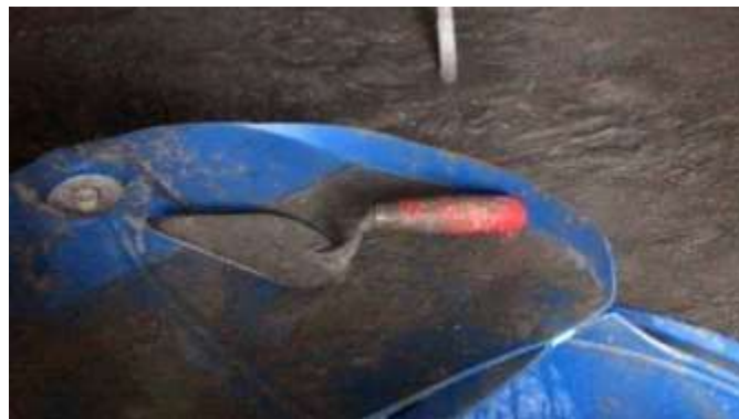
Gambar 3. 141 Sendok Semen ( Sumber : Dokumentasi Lapangan 2023)
