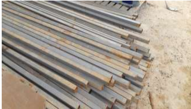
Gambar 3. 106 Besi Hollow ( Sumber : Dokumentasi Lapangan 2023)
