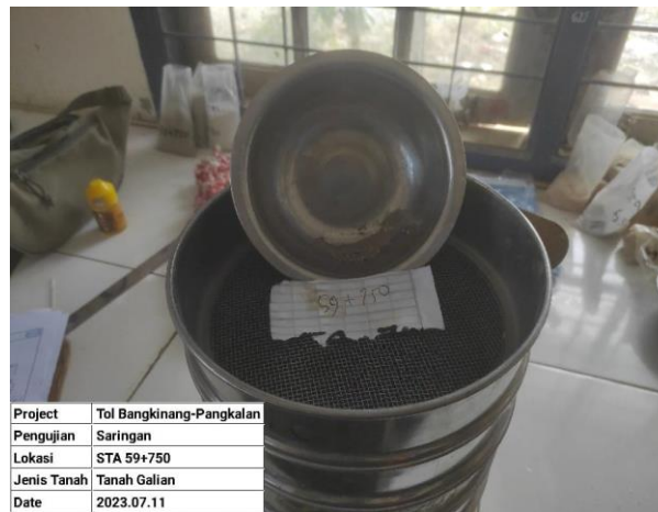
Gambar 4.7 sampel dimasukkan ke dalam saringan Sumber: dokumentasi kerja praktek 2023
