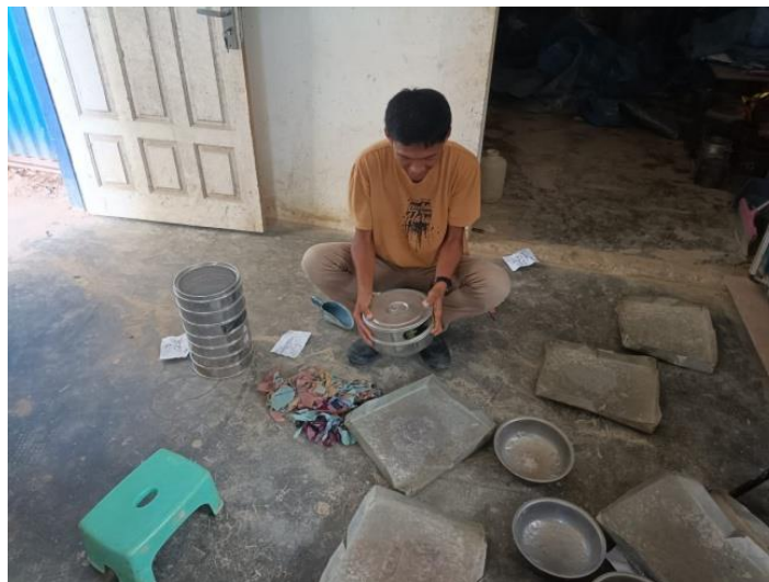
Gambar 3.1 Penujian Gradasi Saringan Laboratorium Sumber: Dokumentasi Kerja Praktek 2023
