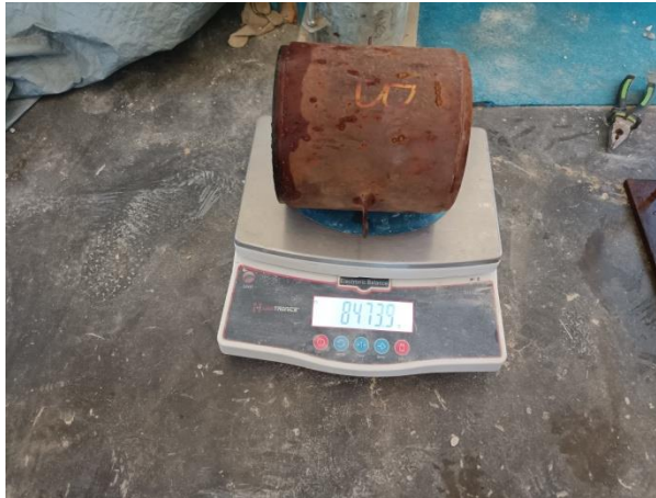
Gambar 4.19 Sampel Ditimbang Sebelum Perendaman Sumber; Dokumentasi Kerja Praktek 2023
