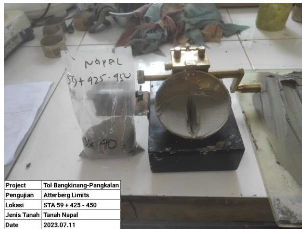
Gambar 4.9 Pengujian LLPL Sumber: Dokumentasi Kerja Praktek 2023
