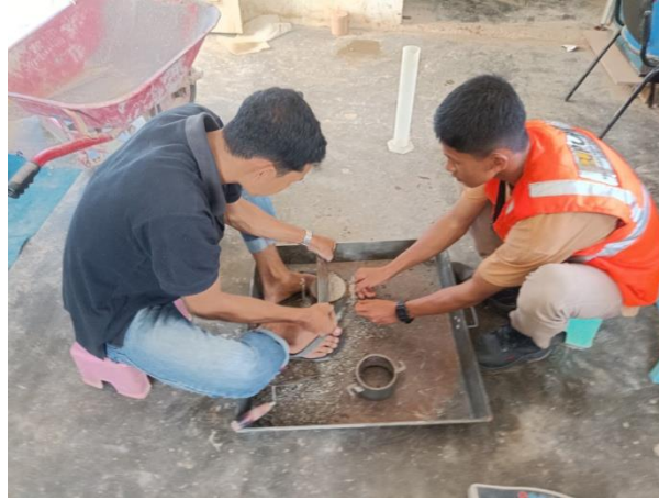
Gambar 4.15 Sampel Diratakan Dengan Mistar Perata Sumber: Dokumentasi Kerja Praktek 2023
