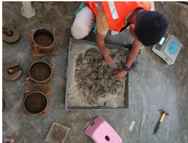
Gambar 4.17 Tanah Dan Air Diaduk Hingga Merata Sumber: Dokumentasi Kerja Pratek 2023
