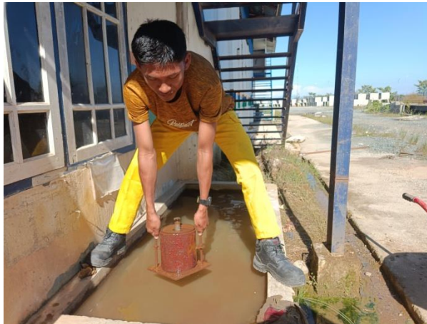
Gambar 4.20 Sampel Direndam Selama 4 Hari Sumber: Dokumtasi Kerja Praktek 2023
