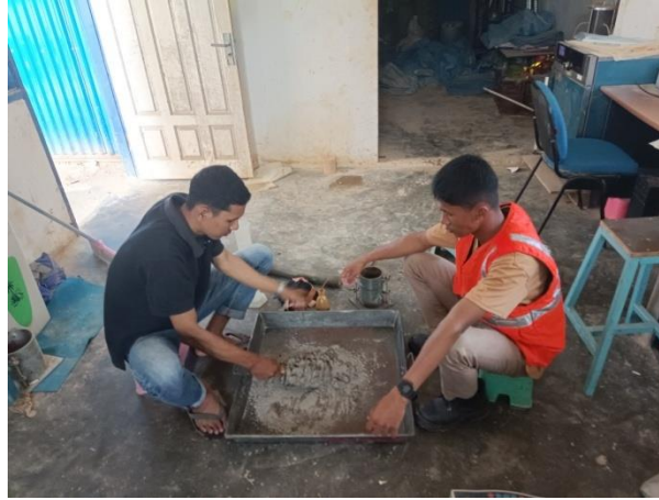
Gambar 4.12 Air Dan Tanah Diaduk Sampai Merata Sumber: Dokumentasi Kerja Praktek 2023
