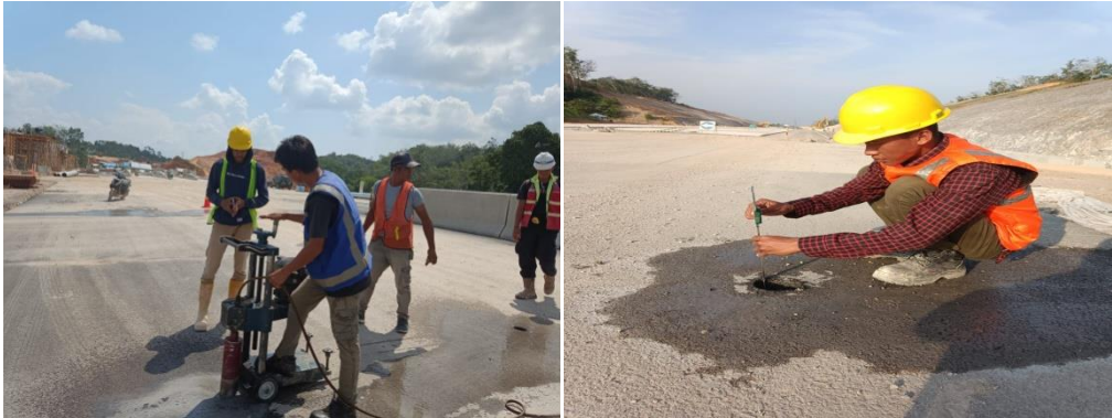
Gambar 3.12 Pengujian Core Drill Aspal Sumber: Dokumentasi Kerja Praktek 2023
