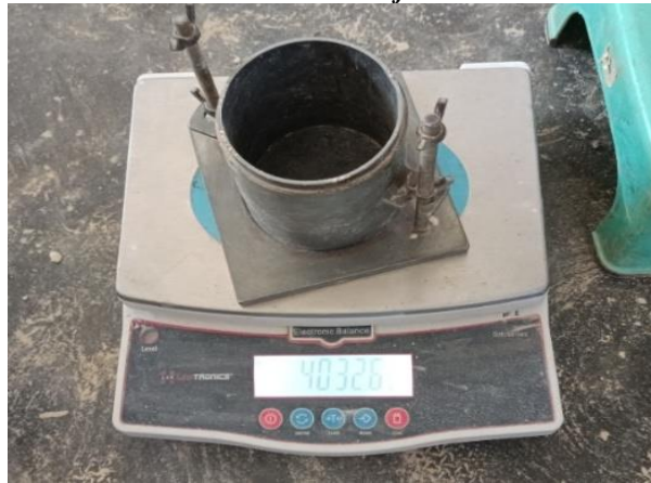
Gambar 4.13 Penimbangan Mould Kosong Sumber: Dokumentasi Kerja Praktek 2023
