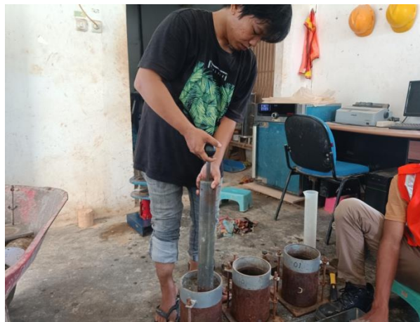
Gambar 4.18 Penumbukan Dengan Metode Standar Sumber: Dokumentasi Kerja Pratek 2023
