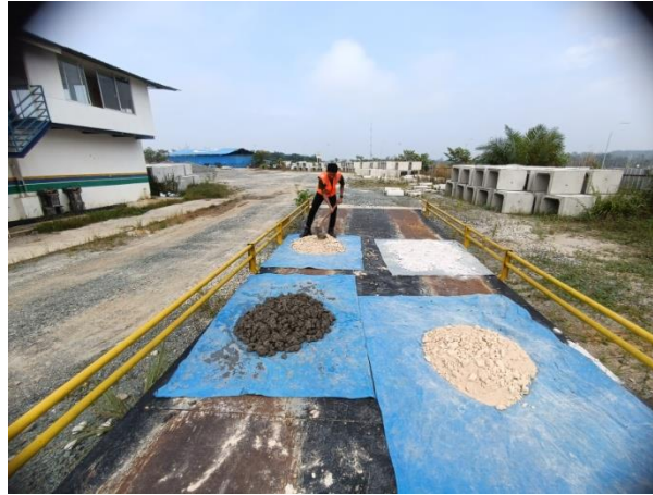
Gambar 4.10 Sampel Pengujian Dijemur Terlebih Dahulu Sumber: Dokumentasi Kerja Praktek 2023
