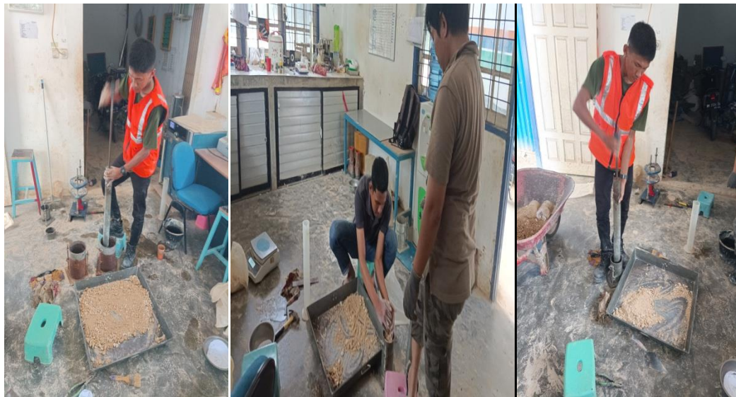
Gambar 3.4 Pengujian Proctor (Kepadatan) Laboratorium Sumber: Dokumentasi Kerja Praktek 2023
