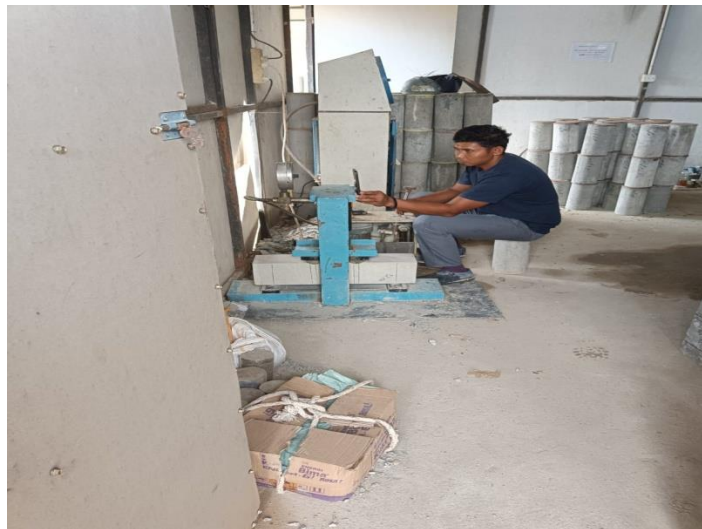
Gambar 3.11 Pengujian Kuat Lentur Beton Sumber: Dokumentasi Kerja Praktek 2023
