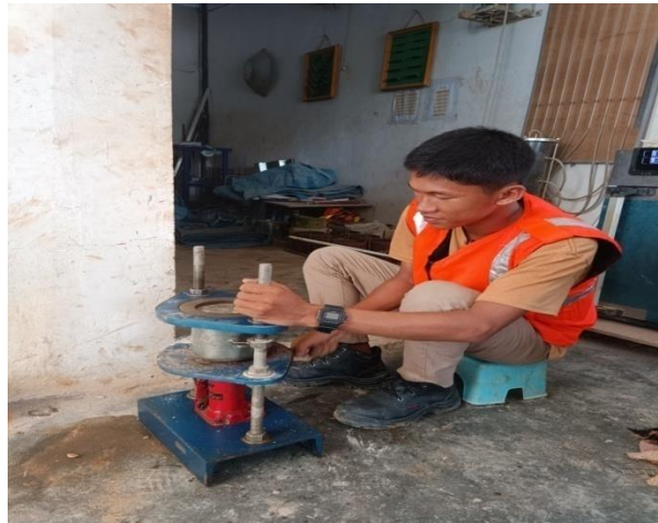
Gambar 4.15 sampel dikeluarkan dengan dongkrak Sumber: dokumentasi kerja prsktek 2023
