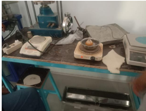
Gambar 4.3 tanah yang berisi air dipanaskan Sumber: dokumentasi kerja praktek 2023
