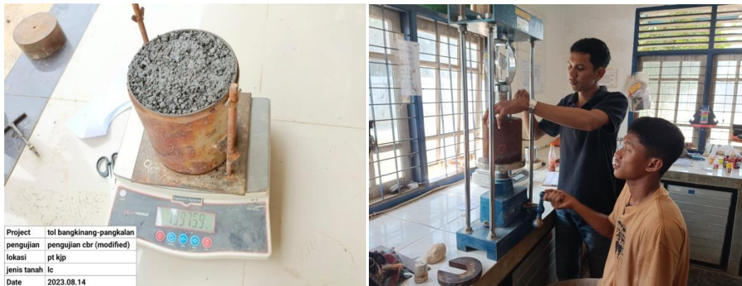
Gambar 3.5 Pengujian CBR Laboratorium Sumber: Dokumentasi Kerja Praktek 2023
