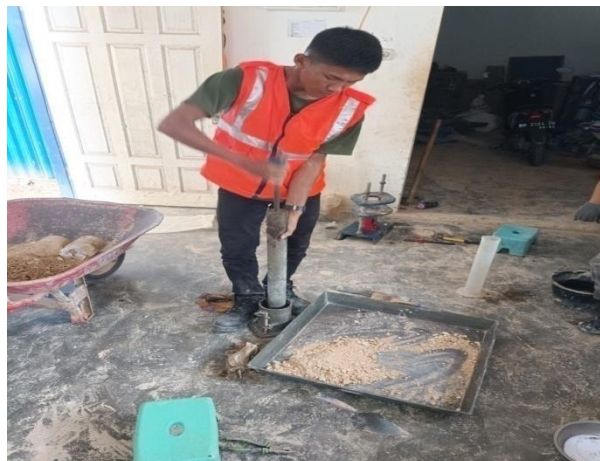
Gambar 4.14 Sampel Ditumbuk Dengan Metode Standar Sumber: Dokumentasi Kerja Praktek 2023
