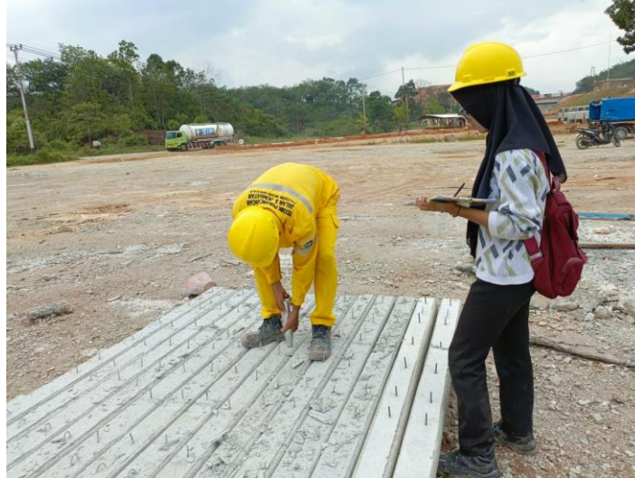
Gambar 3.14 Penguian Hammer Test Sumber: Dokumentasi Kerja Praktek 2023
