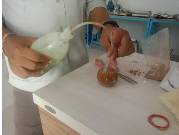
Gambar 4.2 Tanah Didalam Picno Dimasukkan Air Sumber: Dokumentasi Kerja Praktek 2023
