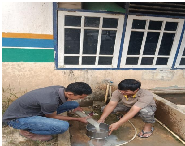
Gambar 4.6 Mencuci Dengan Saringan No.200 Sumber: Dokumentasi Kerja Praktek 2023
