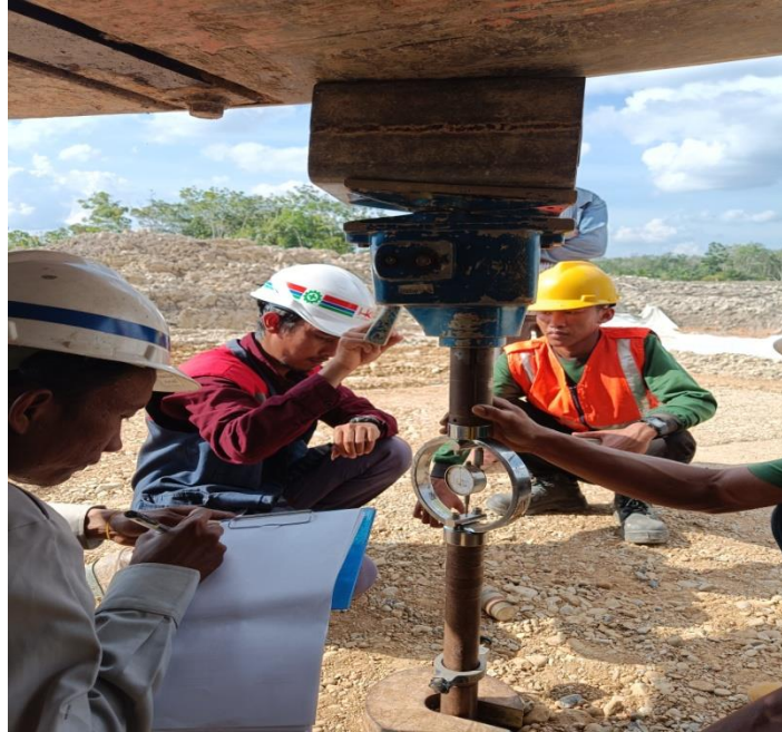
Gambar 3.6 pengujian proofrolling dan CBR lapangan Sumber: dokumentasi kerja praktek 2023
