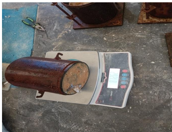
Gambar 4.21 Sampel Ditimbang Setelah Direndam Selama 4 Hari Sumber: Dokumentasi Kerja Praktek 2023
