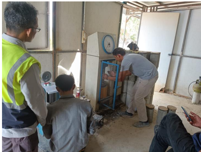
Gambar 3.10 Pengujian Kuat Tekan Beton Sumber: Dokumentasi Kerja Praktek 2023
