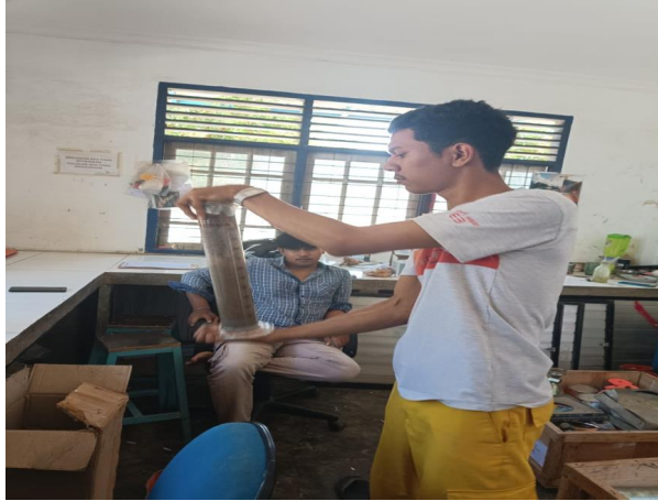
Gambar 4.4 Diputar Sebanyak 60 Kali Putaran Atau 1 Menit Sumber: Dokumentasi Kerja Praktek 2023
