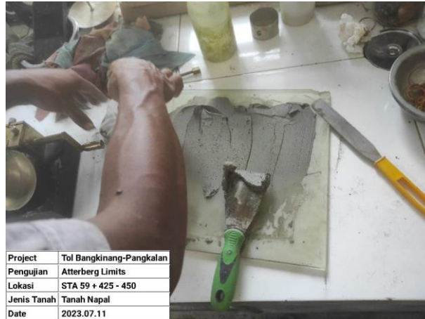
Gambar 4.8 Pengujian LLPL Sumber: Dokumentasi Kerja Praktek 2023
