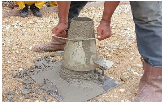
Gambar 4. 16 Melepaskan cetakan sampel uji (Sumber: Dokumentasi Lapangan 2023)
