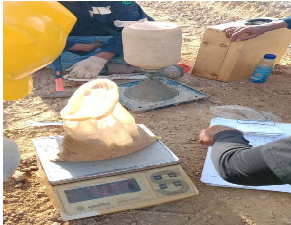
Gambar 3. 6 Pengujian Sand Cone (sumber : Dokumentasi Lapangan, Kerja Praktek 2023)
