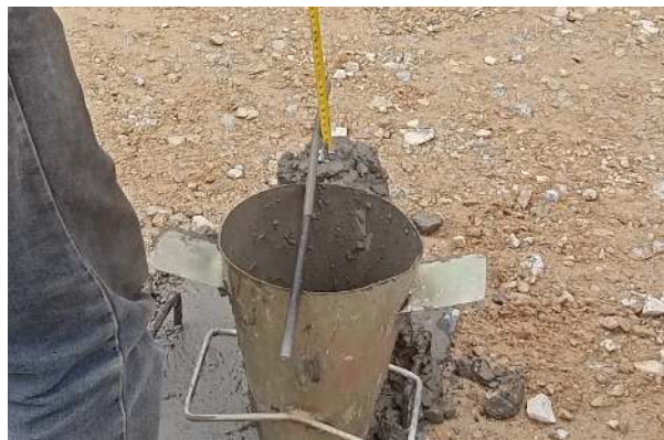
Gambar 4. 17 Pengukuran Slump Test (Sumber: Dokumentasi Lapangan 2023)
