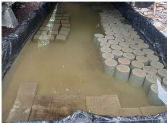
Gambar 3. 35 Sampel Untuk Pengujian Kuat Tekan Beton Sumber: Dokumentasi Lapangan 2023
