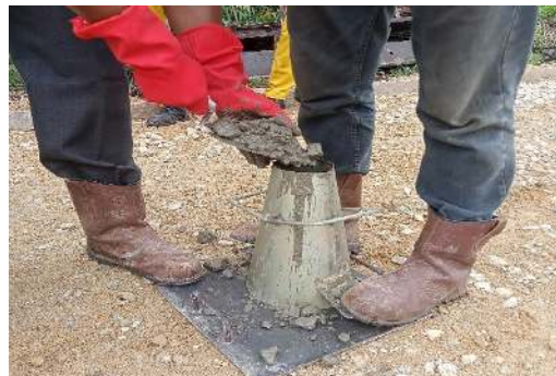
Gambar 4. 13 Memasukan sampel uji kedalam cetakan (Sumber: Dokumentasi Lapangan 2023)
