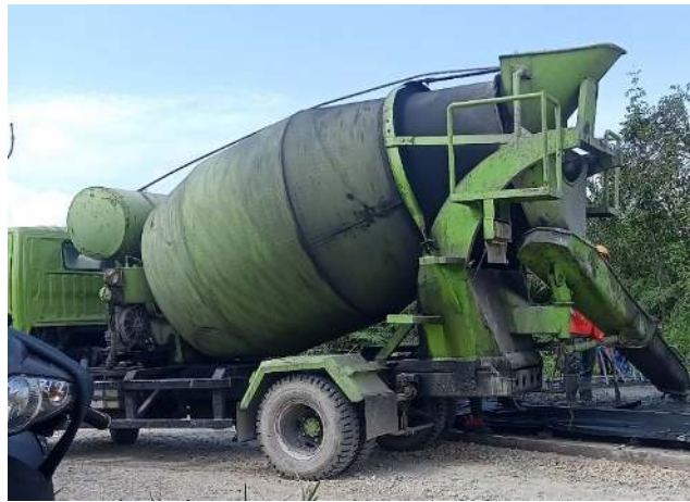
Gambar 4. 1 Truck Mixer (sumber: Dokumentasi Lapangan 2023)
