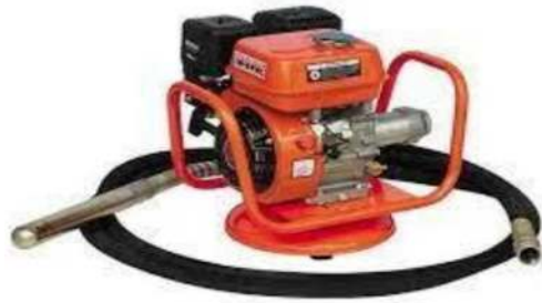
Gambar 2. 10 Concrete Vibrator (Sumber: Dokumentasi Lapangan 2023)
