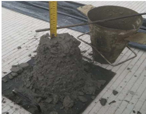
Gambar 3. 28 Pengujian Slump Test Sumber: Dokumentasi Lapangan 2023
