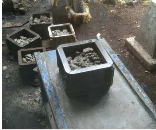
Gambar 3. 29 Pembuatan Sampel Kubus Bahu Jalan Sumber: Dokumentasi Lapangan 2023
