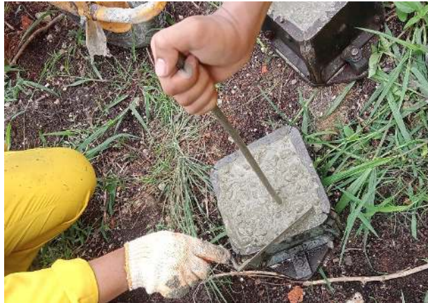
Gambar 4. 20 Penusukan Sampel beton Kubus (Sumber: Dokumentasi Lapangan 2023)
