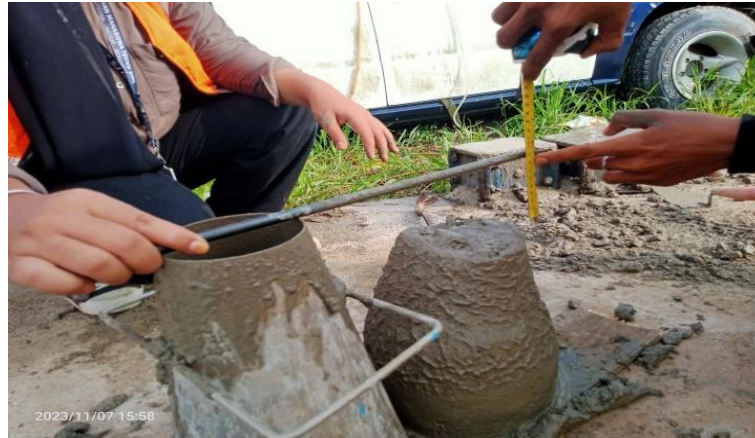
Gambar 3.34 Pengujian Slump Proyek Workshop Sumber : Dokumentasi pribadi di lokasi proyek 2023
