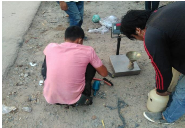
Gambar 3.10. Pengujian Sand Cone
