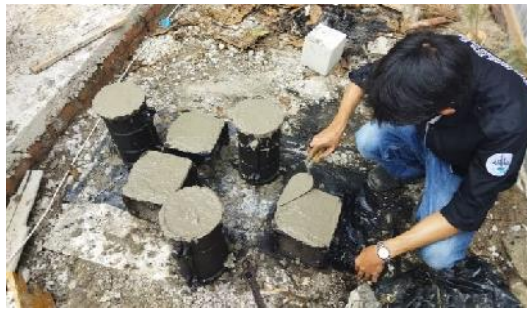
Gambar 3.52 Pembuatan sampel beton silinder dan kubus (Sumber : Dokumentasi Pribadi, 2023)
