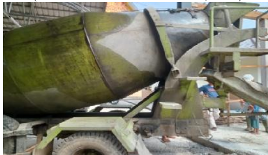
Gambar 3.21 Concrete Truck Mixer (Sumber : Dokumentasi Pribadi, 2023)
