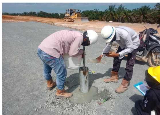
Gambar 3. 2 Pengujian Permeabilitas Tanah
