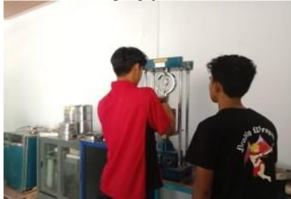
Gambar 3. 11 Pengujian CBR Laboratorium
