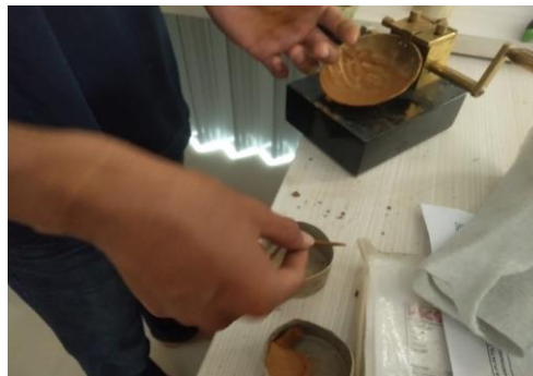
Gambar 3. 8 Pengujian batas plastis
