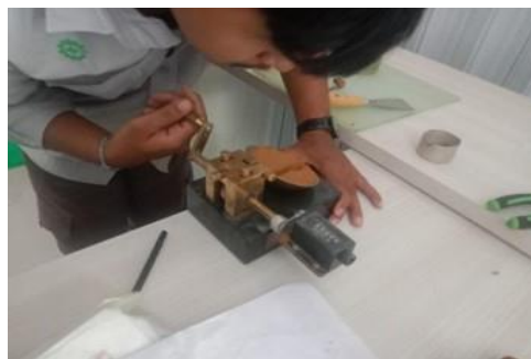
Gambar 3. 9 Pengujian batas cair
