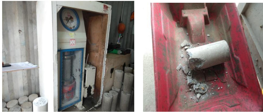
Gambar 3. 13 Pengujian kuat tekan beton
