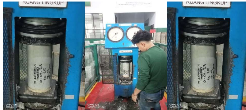
Gambar 3.20 Peletakan sample diatas alat uji kuat tekan Sumber; Dokumentasi Lapangan,2023
