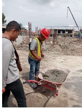
Gambar 3.12 Penusukan sample Sumber; Dokumentasi Lapangan,2023
