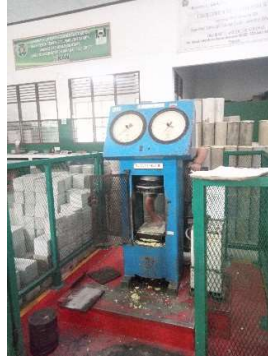
Gambar 3.17 Alat uji kuat tekan Sumber; Dokumentasi Lapangan,2023
