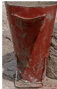
Gambar 3.7 Kerucut abraham Sumber; Dokumentasi Lapangan,2023
