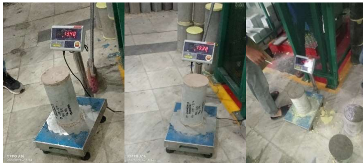
Gambar 3.19 Penimbangan sample Sumber; Dokumentasi Lapangan,2023
