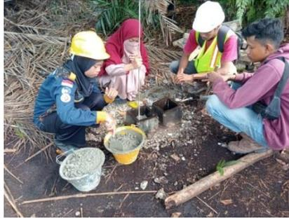
Gambar 3. 9 Pembuatan Sampel Kubus
