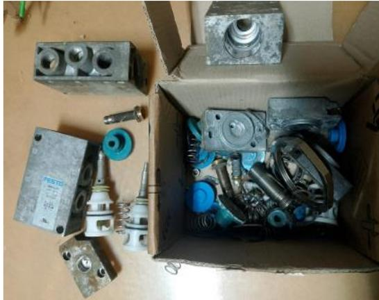
Gambar 2. 9 Membersih Dan Perbaikan Solenoid
