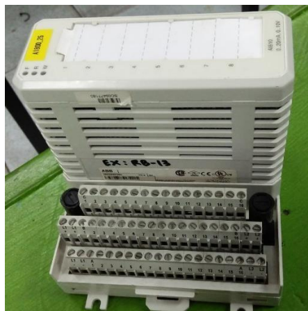
Gambar 3. 8 System I/O S800 (Sumber : Dokumentasi PT. Indah Kiat pulp & paper Tbk Perawang, 2023)
