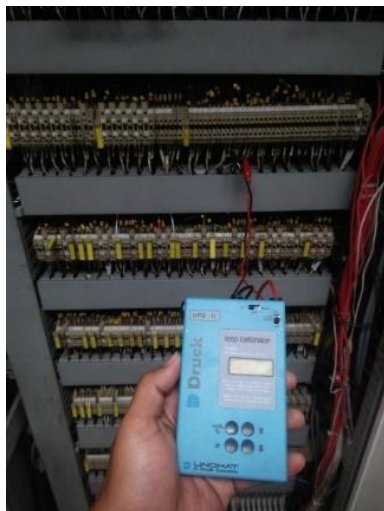
Gambar 2. 4 Simulasi AI dan AO chanel menggunakan Loop Calibrator
