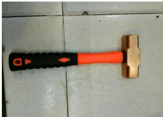
Gambar 4.21 Palu Bondem ( Sumber : Dokumentasi Lapangan )
