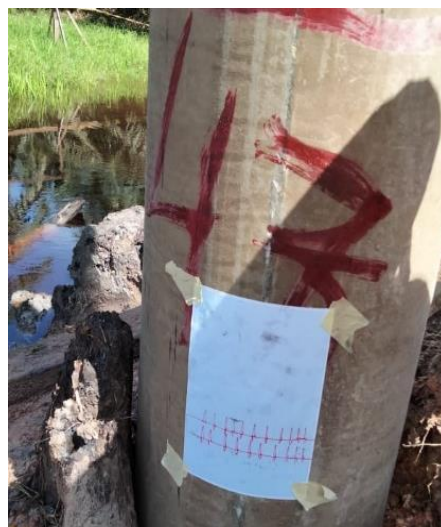
Gambar 3.3 Hasil Grafik Calendring ( Sumber : Dokumentasi Lapangan )
