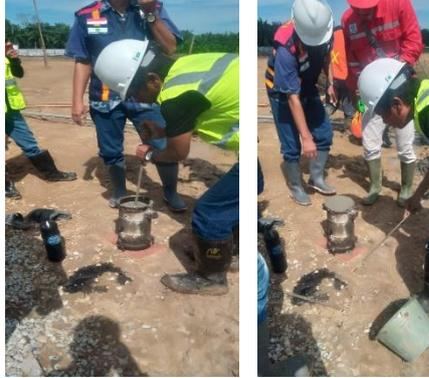
*Gambar 3.36 Proses pembuatan sampel beton silinder
