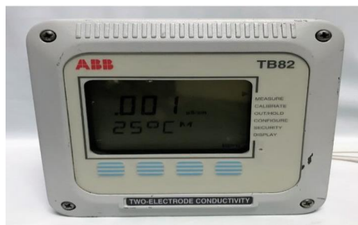
Gambar 3. 1 conductivity transmitter ABB TB82TE 2010100 (Sumber: Dokumentasi PT. Indah Kiat pulp & paper Tbk Perawang, 2023)
