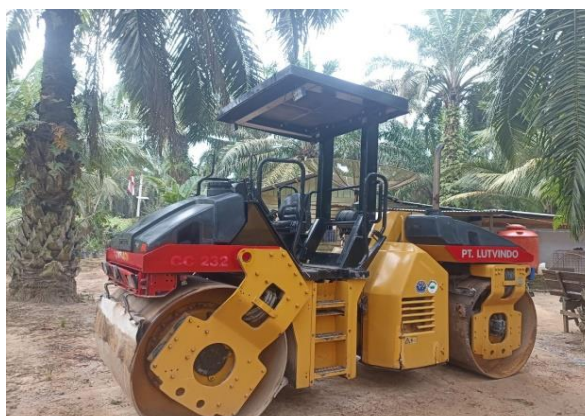
Gambar 3. 9 Tandem Roller Sumber : Dokumentasi lapangan, 2023
