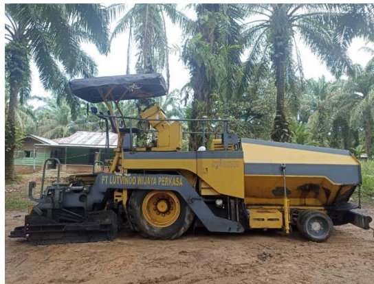
Gambar 3. 7 Asphal Finisher Sumber : Dokumentasi lapangan, 2023
