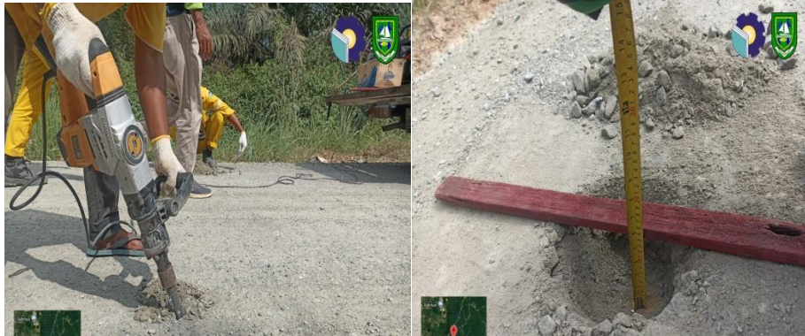
Gambar 3. 23 Pengujian Test pit Base A Sumber : Dokumentasi lapangan, 2023
