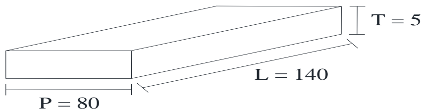
Gambar 3.42 pasir urug dan lantai kerja
