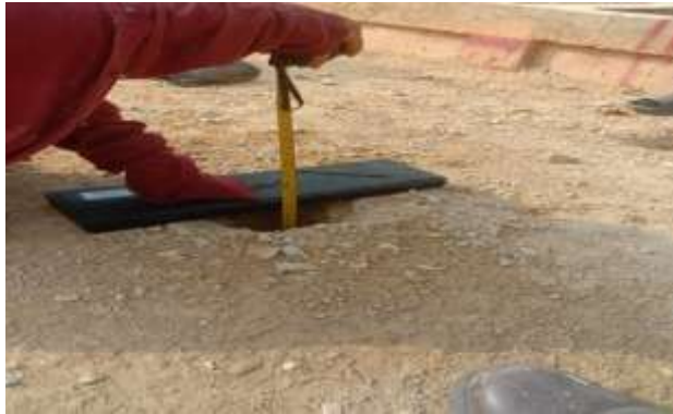
Gambar 3. 14 Pengujian Core Base
