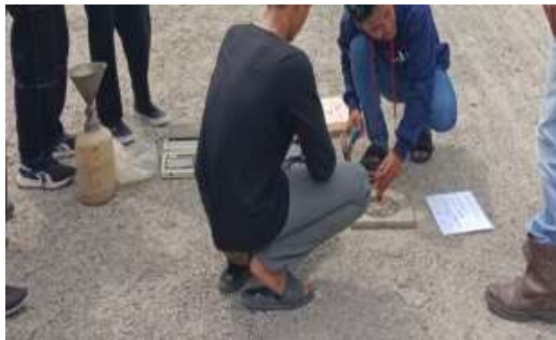
Gambar 3. 27 Pekerjaan sand cone Sumber: Dokumentasi Lapangan
