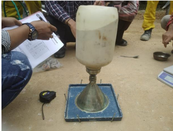
Gambar 3.5 Pengujian Sand Cone Base B Sumber : Dokumentasi lapangan 2023
