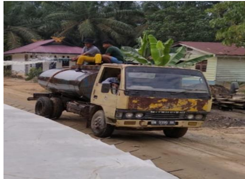
Gambar 3.21 Alat Berat Water Tank Sumber : Dokumentasi lapangan 2023
