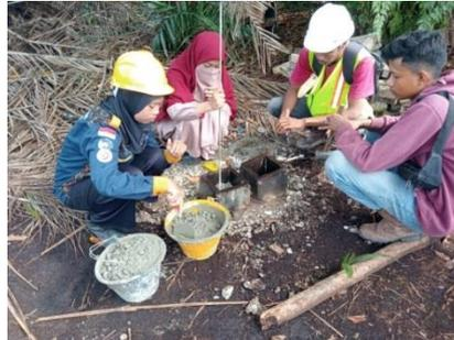
Gambar 3. 8 Pembuatan Sampel Kubus
